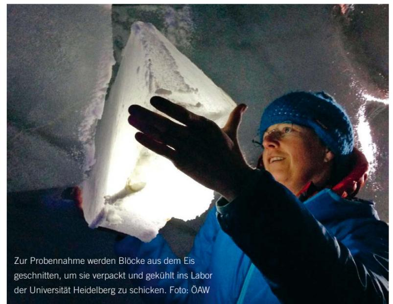
Zur Probennahme werden Blöcke aus dem Eis geschnitten, um sie verpackt und gekühlt ins Labor der Universität Heidelberg zu schicken. Foto: ÖAW
