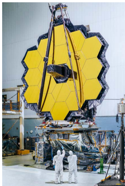
Der Primärspiegel des JWST während der Testphase. Foto: NASA
